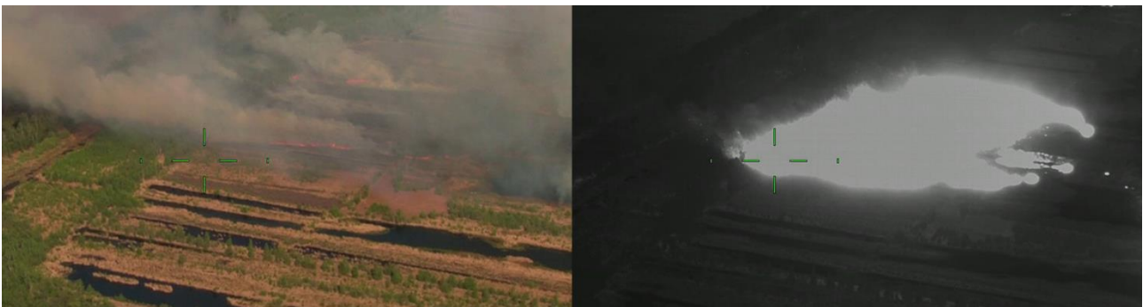
Afbeelding 5.13: Normale beeldopname en opname gemaakt met een warmtebeeldcamera. Bron: dienst luchtvaart politie
