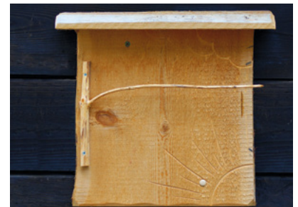
Voorbeeld zelfgemaakte barometer.
