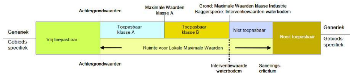
Figuur 1: Normstelling voor het toepassen van grond en baggerspecie in oppervlaktewater in het generieke- en gebiedsspecifieke kader.
