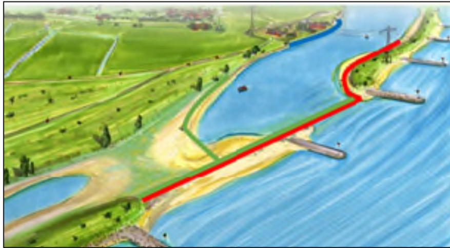
Figuur 16: Locaties bij de grote nevengeul met aan te brengen bodembescherming
