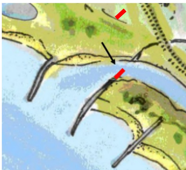
Figuur 5: Detail uitstroomopening kleine nevengeul op de Waal met in rood schematisch aangegeven het mogelijke restant van een (tot op de bodem van de nevengeul) te verwijderen krib in de ondergrond
