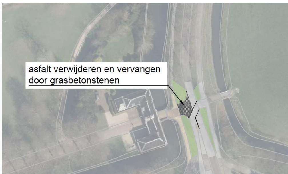
Figuur 5.1: schetsontwerp aanpassing verharding t.h.v. poortgebouw
