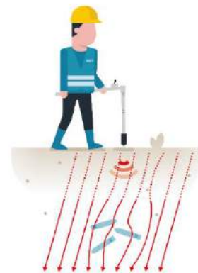
Figuur 6: Werkingsprincipe passieve detectie
